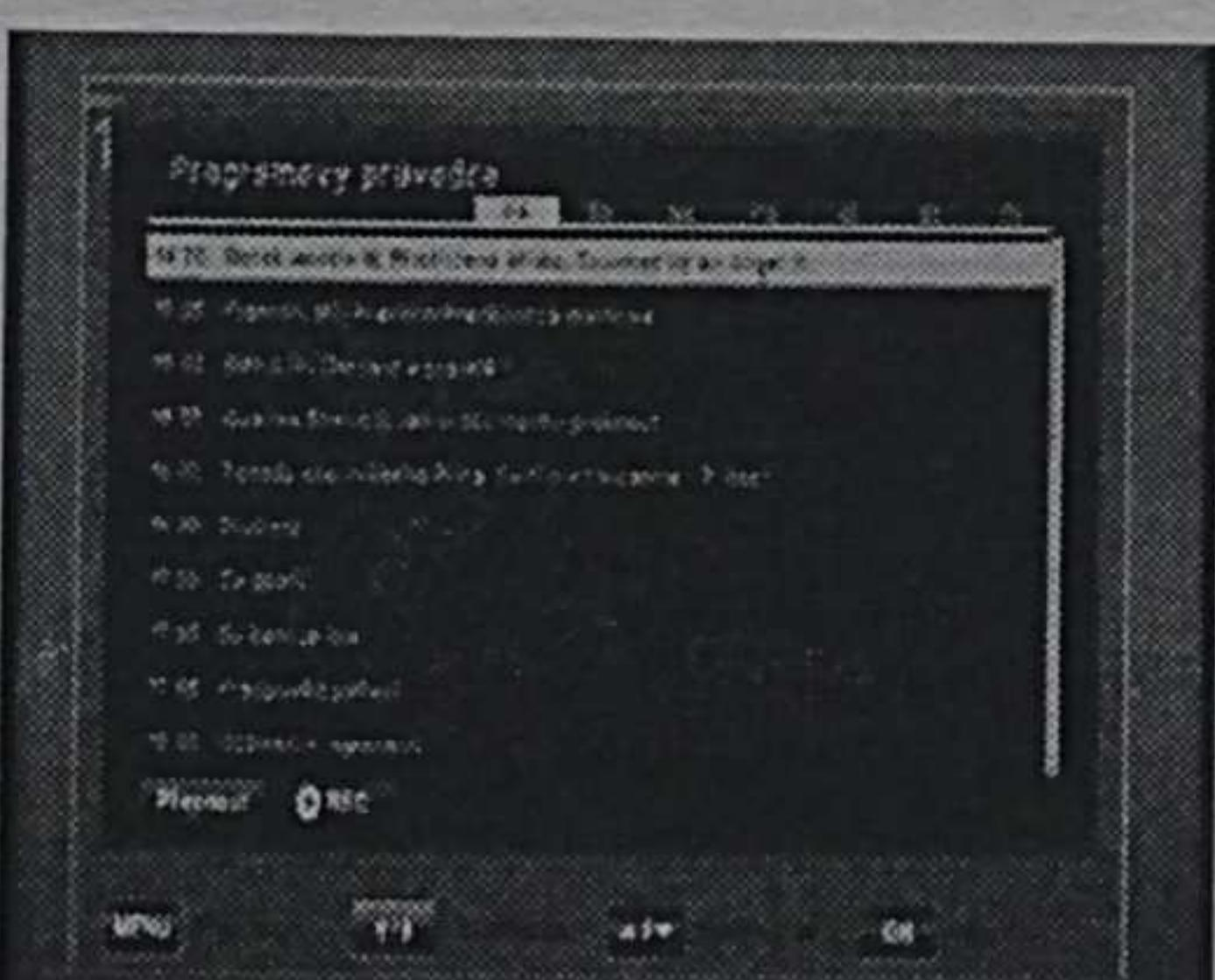
Po stlačení ZELENÉHO tlačidla (Prepnúť) sa zobrazí druhá úroveň EPG. Táto aplikácia poskytuje kompletné informácie EPG pre vybraný kanál. Je možné rolovať po programoch v chronologickom poradí pre určitý deň tlačidlami KURZOR HORE a KURZOR DOLE. Použitím tlačidiel DOLAVA a DOPRAVA vyberte iný deň.
