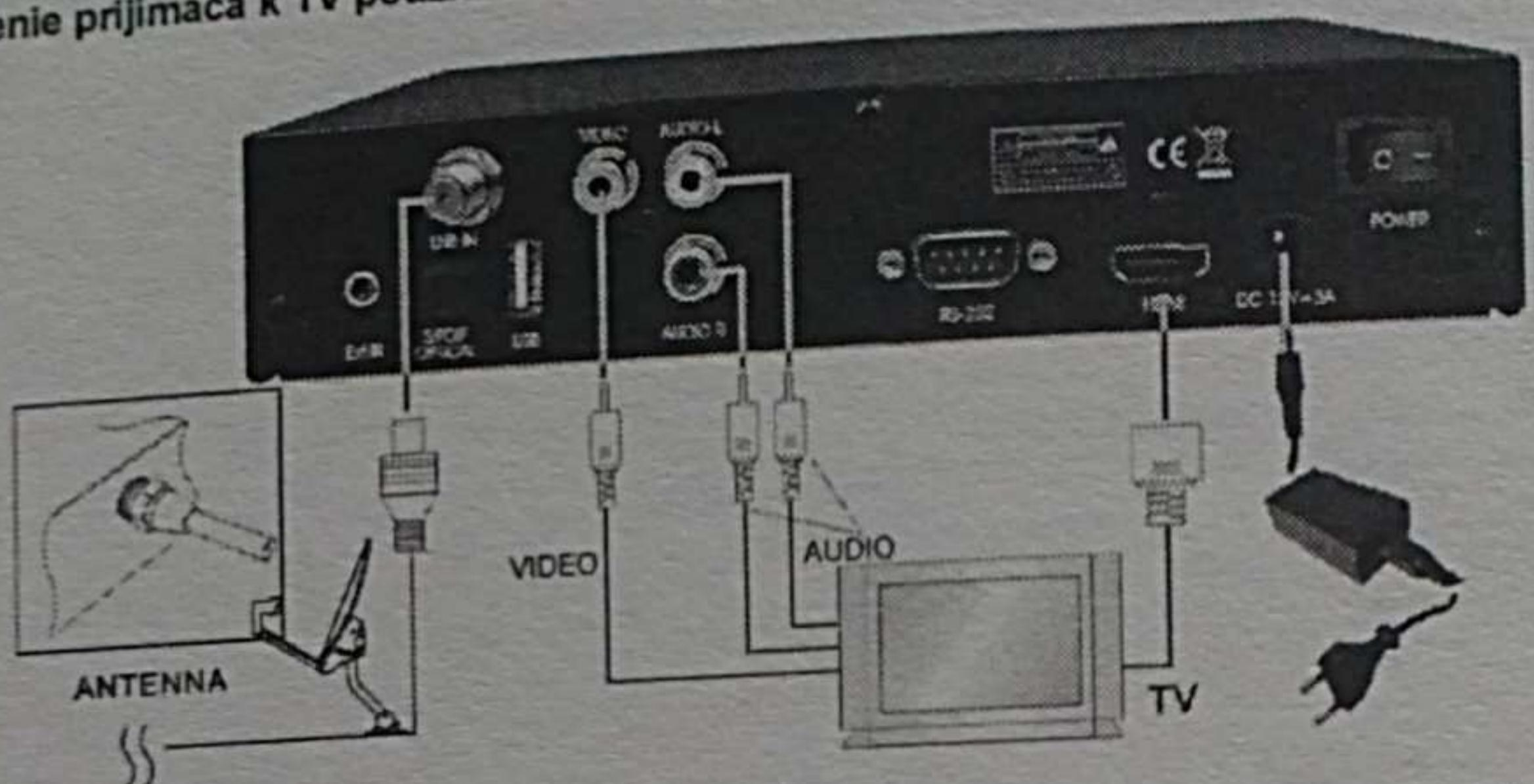
Pripojte koaxiálny kábel (kábel zo satelitnej paraboly) ku konektoru označenému "LNB IN" na zadnej strane prijímača.
